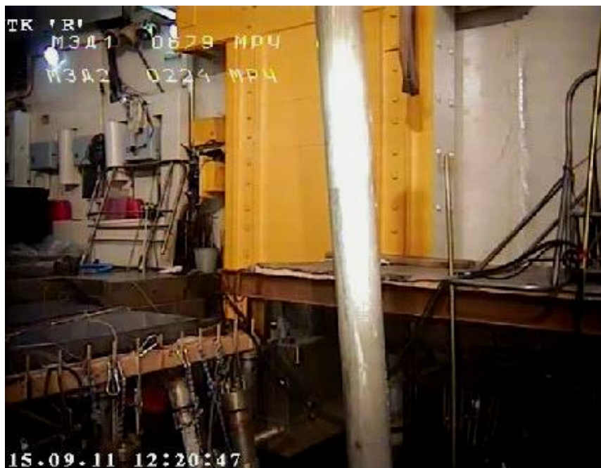
Рисунок 9. Изображение, полученное от радиометрической системы роботизированного комплекса «Брокк-90», и содержащее информацию о мощности дозы на открытых и коллимированных детекторах.
