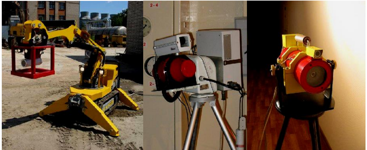
Рисунок 7. а) Радиометрическая система роботизированного комплекса Брокк-90, б) дистанционно управляемая портативная спектрометрическая система, с) портативная гамма-камера «Gammavisor».
