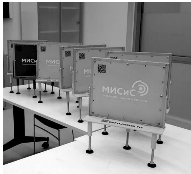
Рисунок 4.24 Сборочный чертеж для а) детектора, б) крышки детектора, в) алюминиевой рамы, г) - принципиальная схема конструкции детектора с фотоэмульсионными слоями, указанные на схеме размеры конструкции представлены в миллиметрах; д) – внешний вид собранных детекторов, готовых к установке на объекте.
