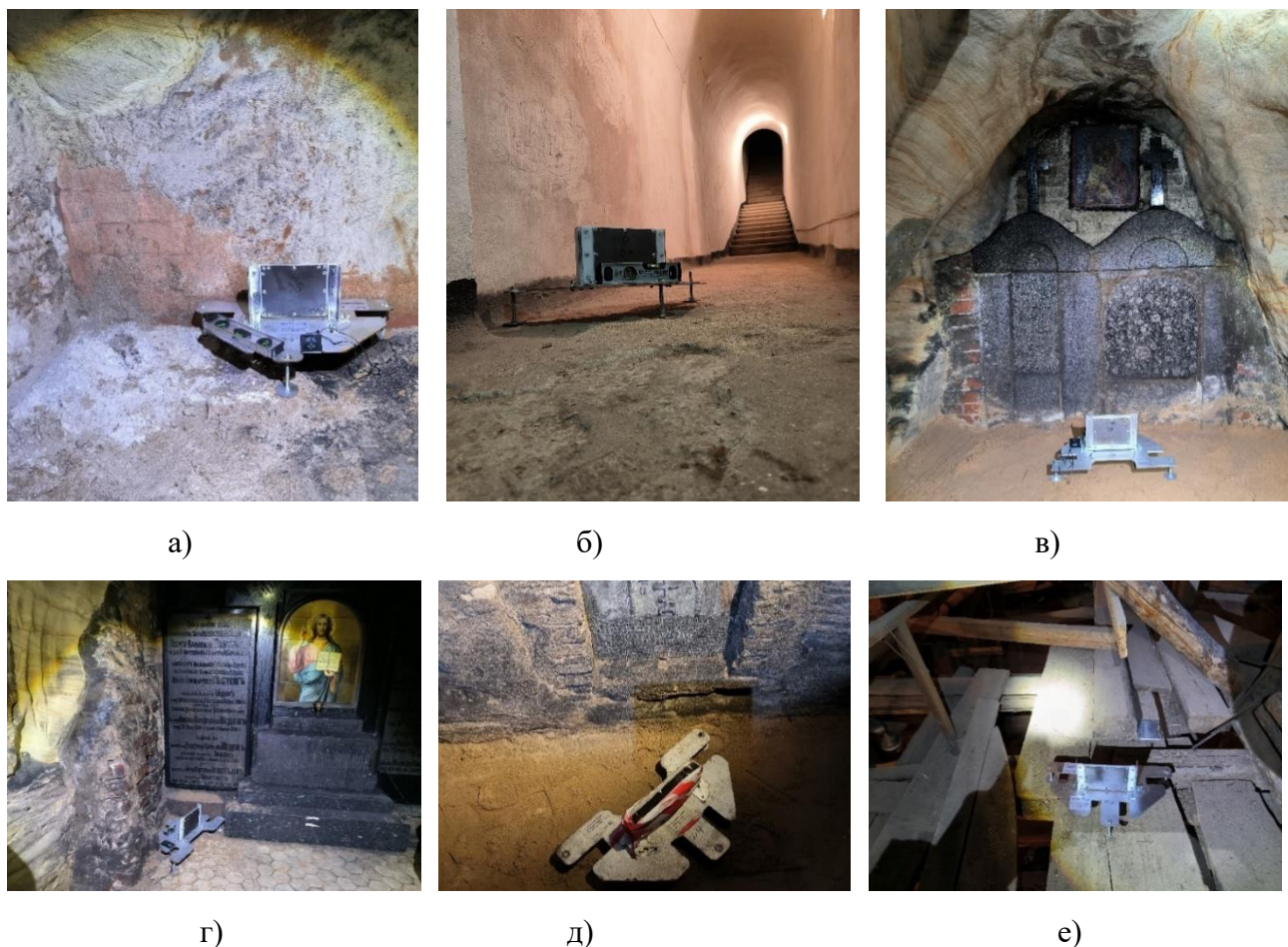
Рисунок 4.55 Фото детекторов на месте экспозиции: а) детектор 7 расположен на Братской улице и направлен на исследуемую зону II; б) детектор 11, расположен на Старцевом «переулке» пещер и направлен на исследуемую зону I (склеп); в) детектор 9 расположен в конце Троицкой улицы, направлен на исследуемую зону II; г) детектор 5, расположен на Братской улице, направлен на исследуемую зону II; д) детектор 4, расположен на Троицкой улице и просматривает Братскую улицу пещерного храма; е) детектор на чердаке для измерения фона.
