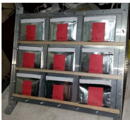
Рисунок 4.17 а) Сборочный чертеж конструкции детектора, размеры приведены в миллиметрах; б) фото укладки девяти эмульсионных стопок в светонепроницаемые пакеты и их положение внутри рамки детектора; в) – внешний вид детектора с соответствующей разметкой в собранном виде; г) – фото детектора на месте экспозиции.
