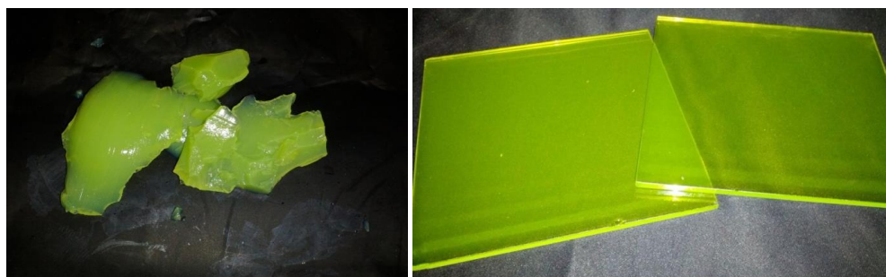
Рисунок 1.5 а) Готовый эмульсионный гель; б) эмульсионный гель, политый на стеклянную основу. Фото сделано в тёмной комнате при помощи инфракрасной фотокамеры.
