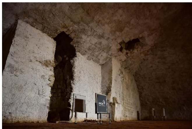
Рисунок 4.25 Пример установки детекторов первой экспозиции в открытых подвалах ЦПБМ.
