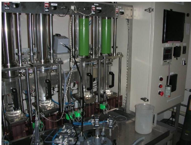
Рисунок 1.10 Внешний вид машины в университете Нагойи для производства эмульсионного геля путем осаждения.
