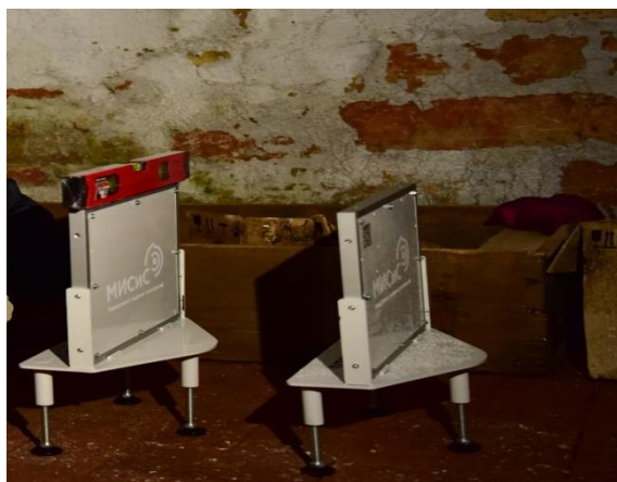
Рисунок 4.25 Пример установки детекторов первой экспозиции в открытых подвалах ЦПБМ.
