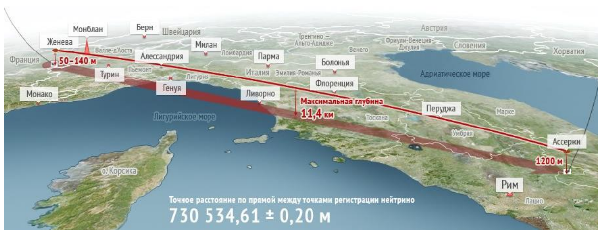
Рисунок 2.5 Схема прохождения пучка нейтрино от ЦЕРН до LNGS.
