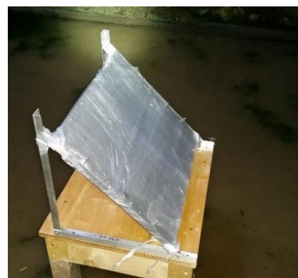
Рисунок 4.17 а) Сборочный чертеж конструкции детектора, размеры приведены в миллиметрах; б) фото укладки девяти эмульсионных стопок в светонепроницаемые пакеты и их положение внутри рамки детектора; в) – внешний вид детектора с соответствующей разметкой в собранном виде; г) – фото детектора на месте экспозиции.
