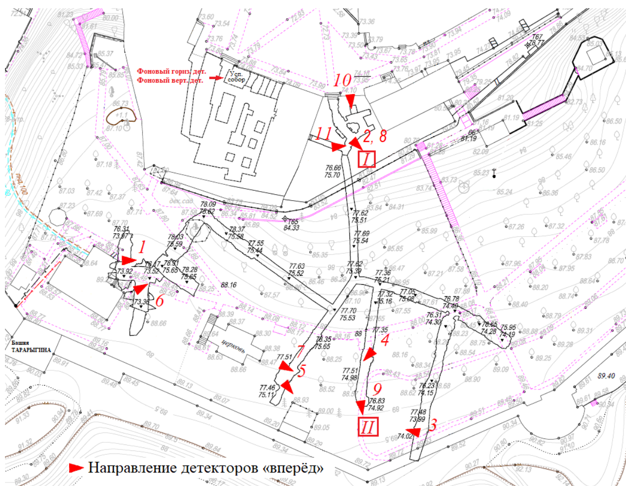
Рисунок 4.52 Схема расположения детекторов в пещерах Свято-Успенского Псково-Печерского монастыря. Треугольниками обозначено положение детекторов. Острые концы треугольников указывают направление обзора для исследования объектов. Два квадрата на рисунке, обозначенные цифрами I и II, показывают области исследуемых объектов.
