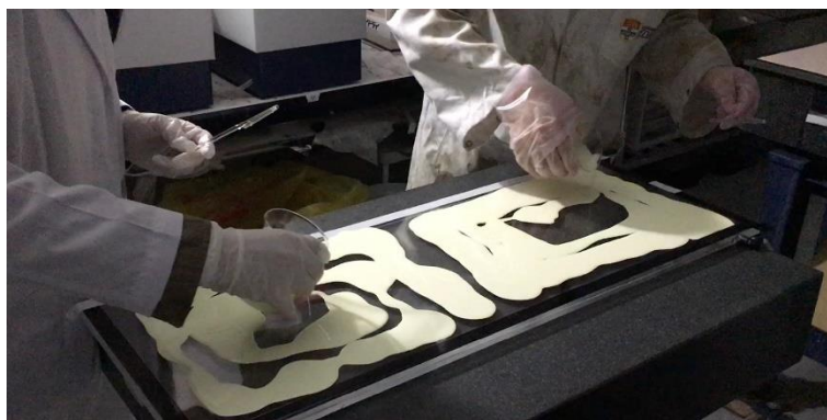
Рисунок 1.9 Вакуумный стол для ручного полива ЯФ на ТАЦ подложку в лаборатории университета Нагойя, Япония.
