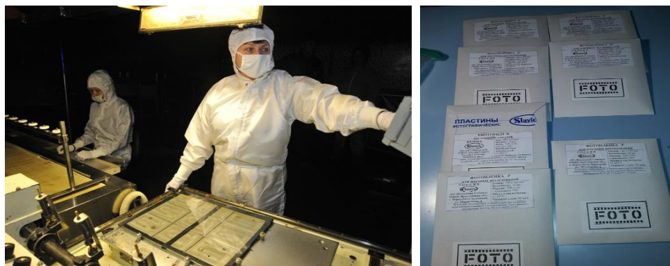
Рисунок 1.8 Резка литой пленки /стекло/ на различные форматы, упаковка (слева) и внешний вид готовой продукции (справа) на производстве ООО “СЛАВИЧ”.
