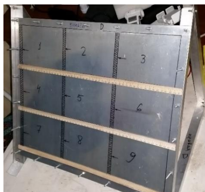
Рисунок 4.17 а) Сборочный чертеж конструкции детектора, размеры приведены в миллиметрах; б) фото укладки девяти эмульсионных стопок в светонепроницаемые пакеты и их положение внутри рамки детектора; в) – внешний вид детектора с соответствующей разметкой в собранном виде; г) – фото детектора на месте экспозиции.
