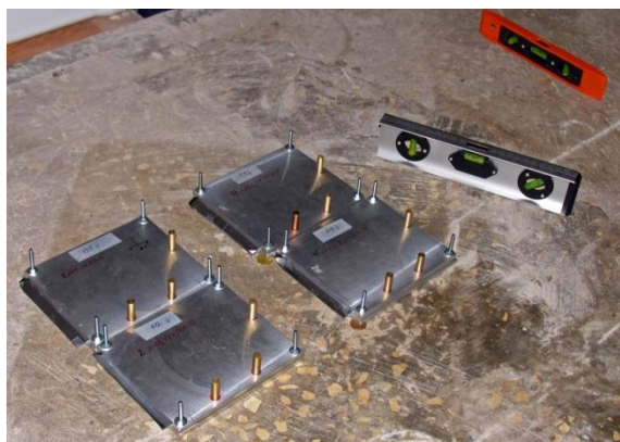
Рисунок 4.8 Фото четырех детекторов, установленных под землей на глубине 30 метров.
