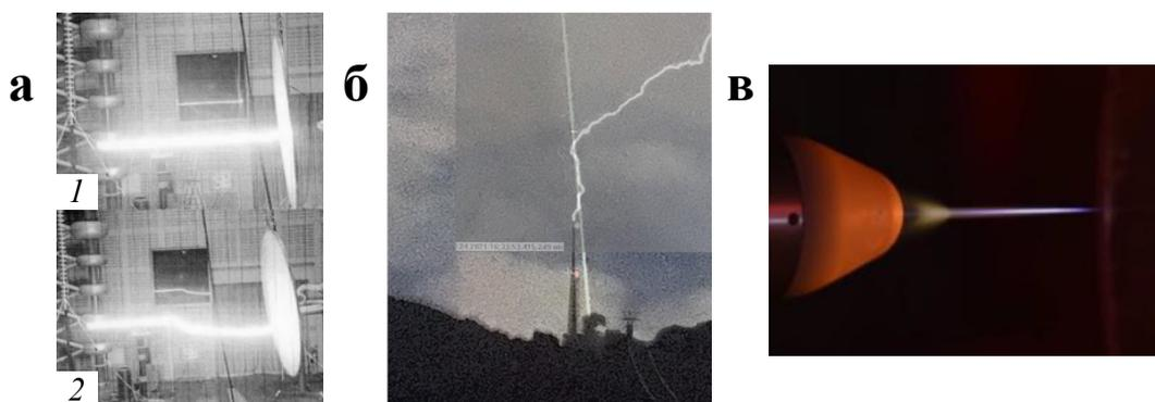
Рисунок 1.8 — Иллюстрации применений филаментации: а) 1 – лазерно управляемый разряд, 2 – пробой между электродами [78]; б) снимок молнии, записанный в присутствии лазерного луча (траектория лазерного луча наложена отдельно) [80]; в) фотография тестовой модели, перед которой создан филамент, в потоке воздуха, соответствующем скорости 3 Маха [81].
