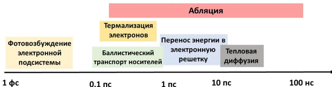
Рис.1.1. Схема поглощения энергии и фазовые превращения после возбуждения материала ультракороткими лазерными импульсами для металлов
