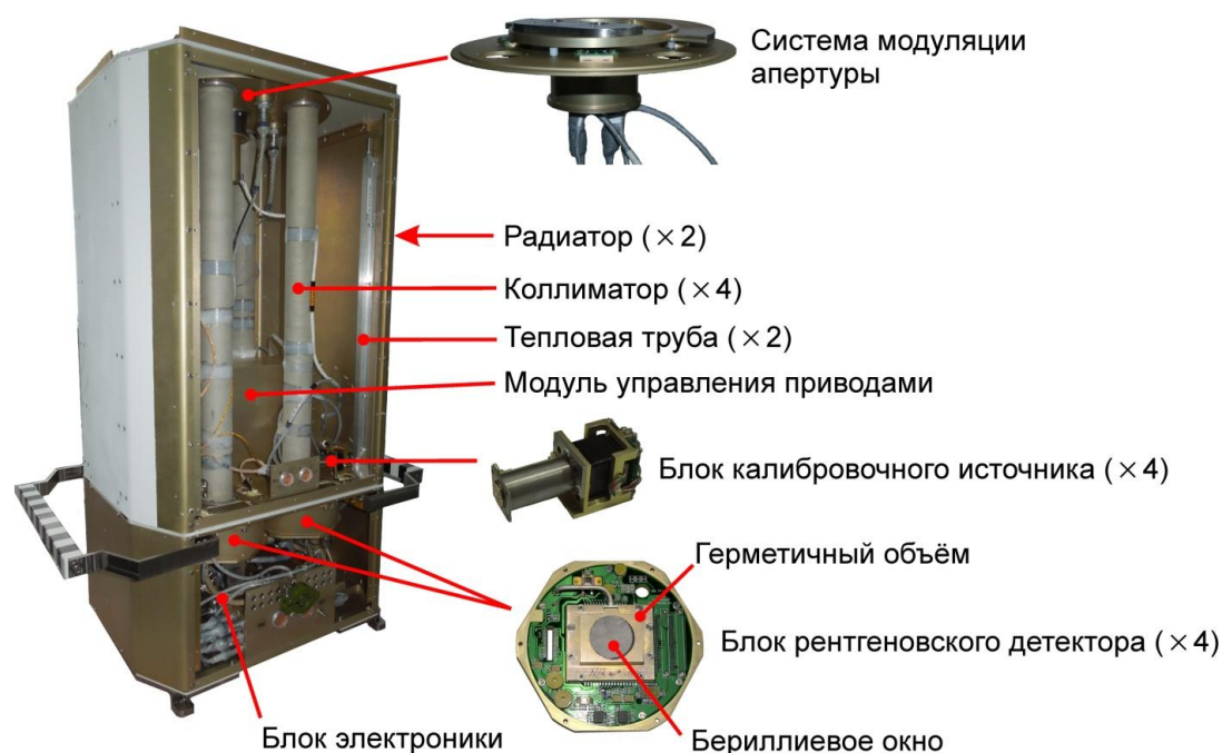
Рисунок 3.2 – Основные составные части СПИН-X1-MVN (совместный результат из работы Сербинов и др., 2022)
