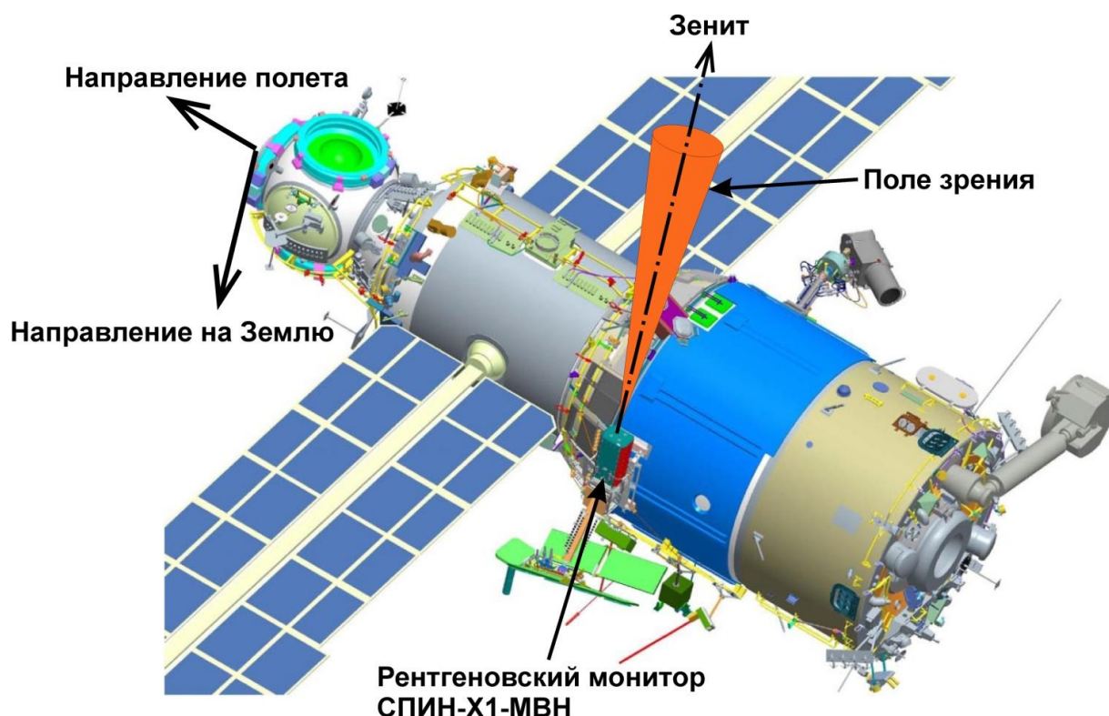
Рисунок 2.2 – Рентгеновский монитор СПИН-X1-МВН на универсальном рабочем месте российского модуля «Звезда» Международной космической станции
