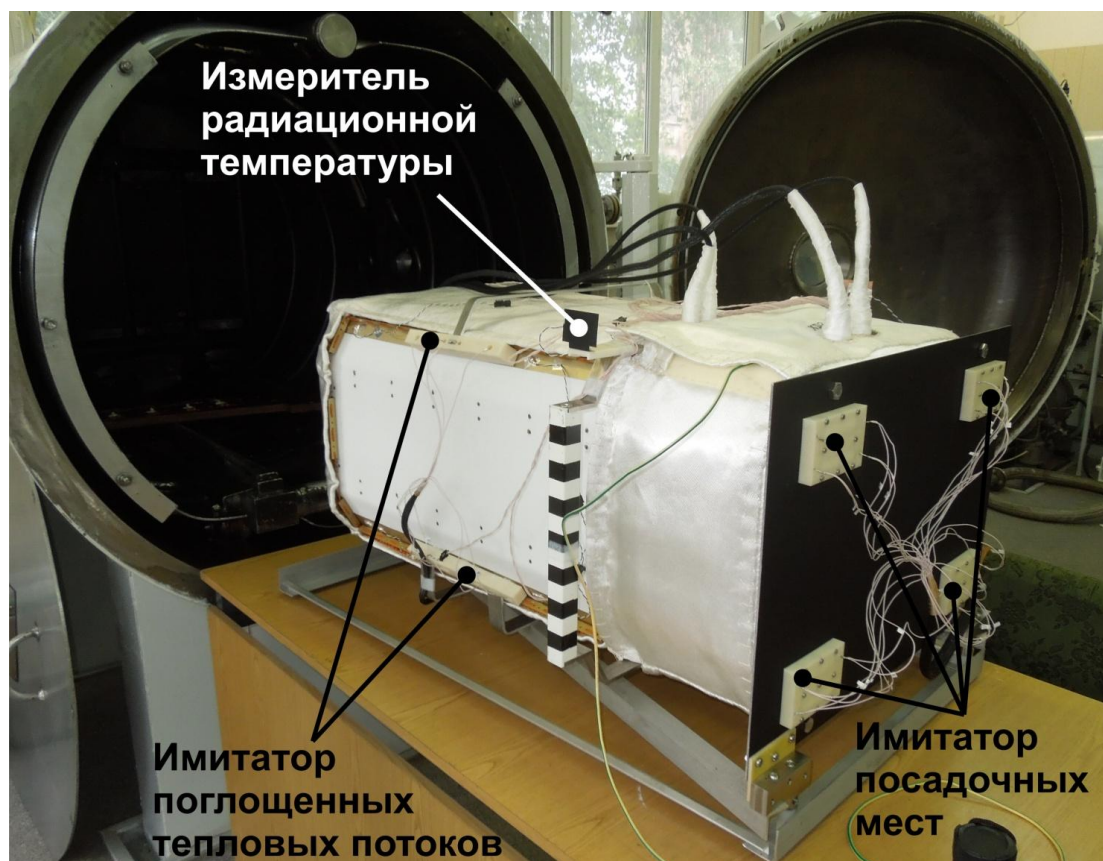
Рисунок 4.1 – СПИН-X1-МВН перед установкой в термовакuumную камеру (совместный результат из работы Serbinov et al., 2017)
