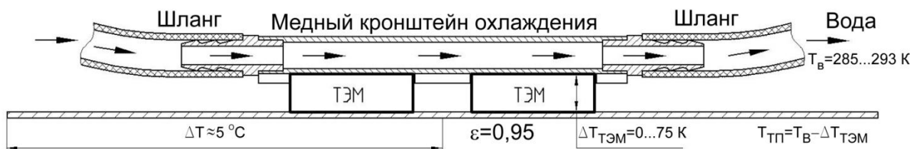
Рисунок 4.7 – Схема охлаждения одной тепловой панели экрана (иллюстративный рисунок)
