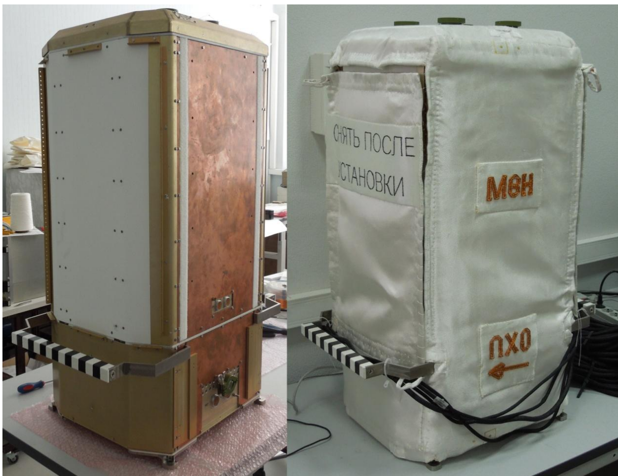
Рисунок 3.1 – СПИН-X1-MBH (слева – без ЭВТИ, справа – обшитый ЭВТИ) (иллюстративный рисунок)
