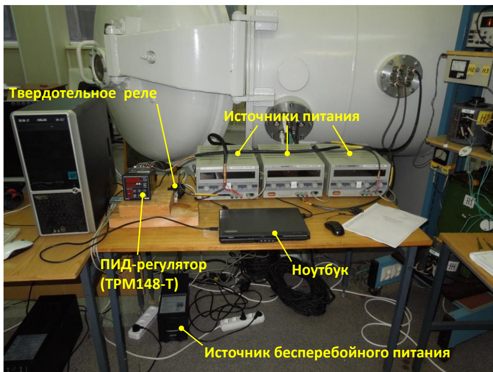
Рисунок 4.3 – Система управления комплексом обеспечения ТВИ МВН (иллюстративный рисунок)
