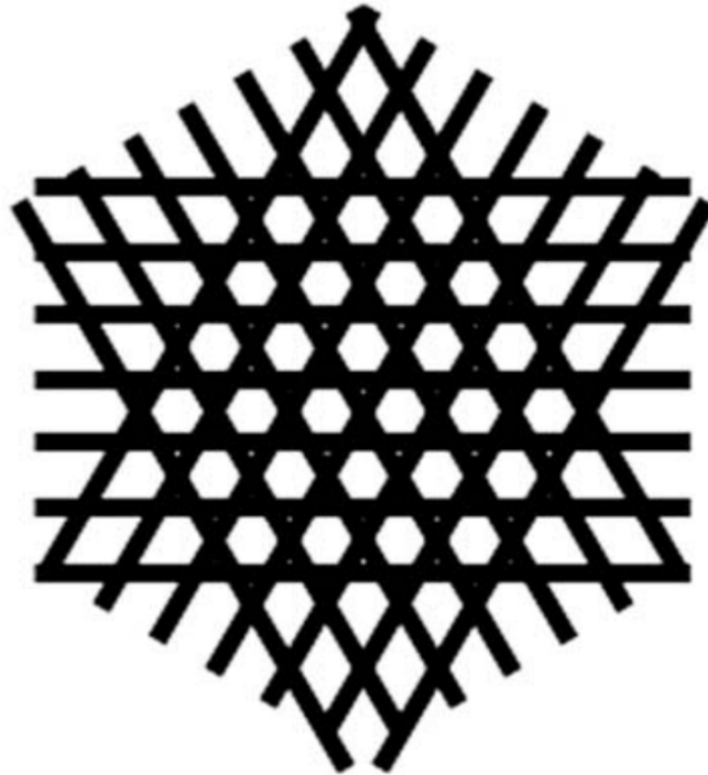
Рисунок 2.9: Схема построения планарного фотонного кристалла при помощи набора прямых линий. Источник [148].
