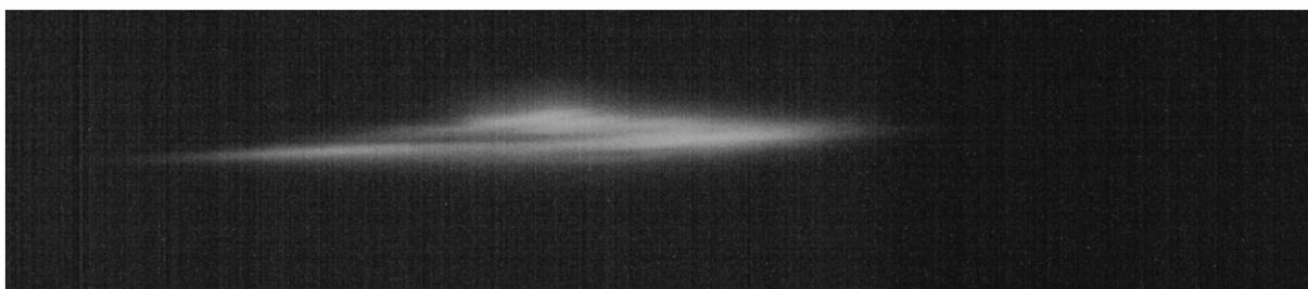
*Рис. 4.12 Изображение плазменных каналов при фокусировке импульса с энергией 1.7 мДж линзой с фокусным расстоянием 2 см, полученное при помощи микроскопа (ширина изображения 1.2 мм)*
