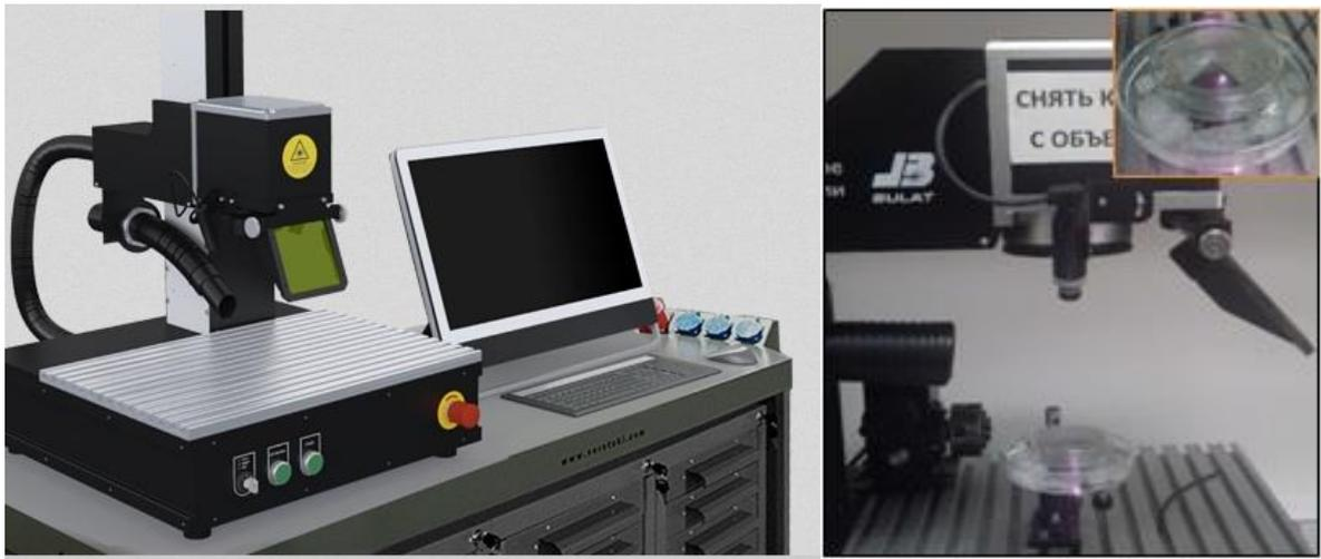
Рис. 2.6. Наносекундный лазер HTFMARK (Буллат)
