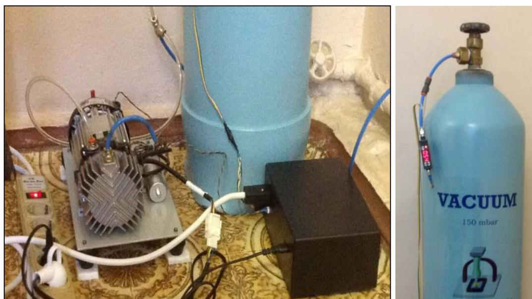
Рис. 7. Вакуумный насос и устройство поддержания давления в системе а) насос и блок управления; б) электронный датчик давления и вакуумный
