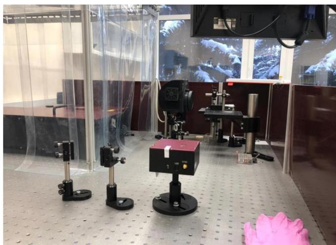
Рисунок 3.15. – Установка для лазерной абляции.
