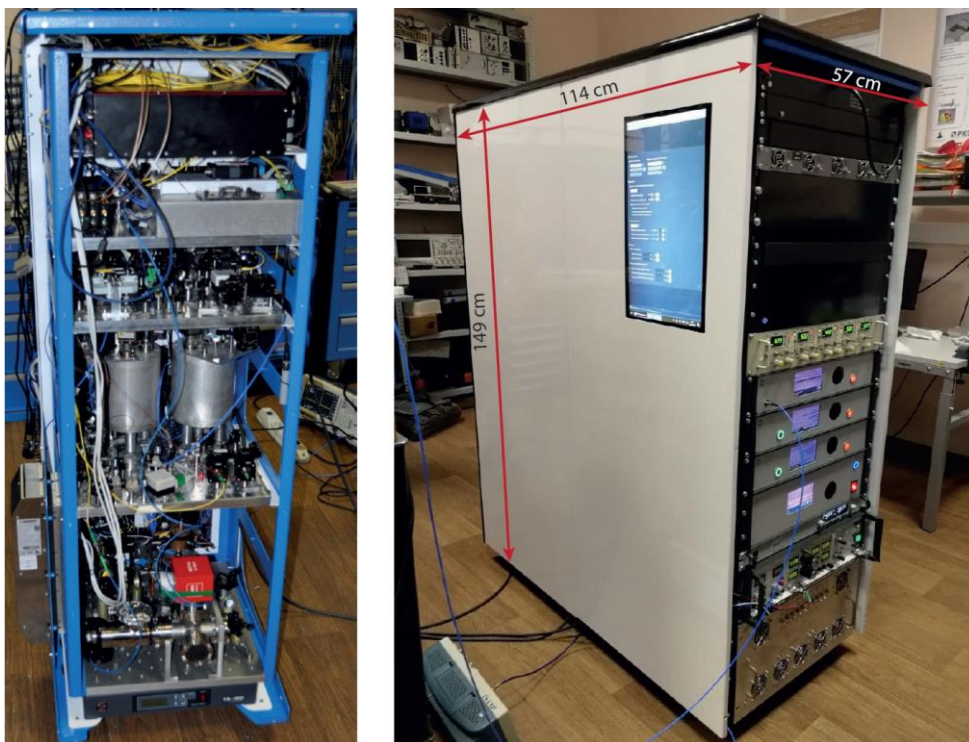
Рис. 46. Созданный прототип транспортируемых оптических часов на одиночном ионе иттербия-171.
