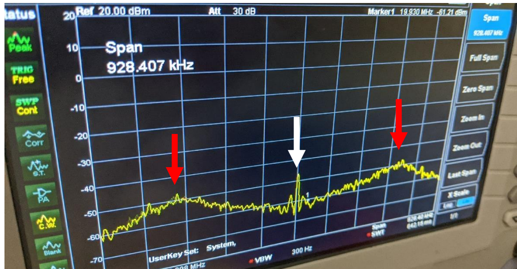
Рис. 23. Спектр сигнала с фотодиода ПДХ при активированной обратной связи. Красные стрелки – максимумы, белая – частота модуляции 20 МГц.
