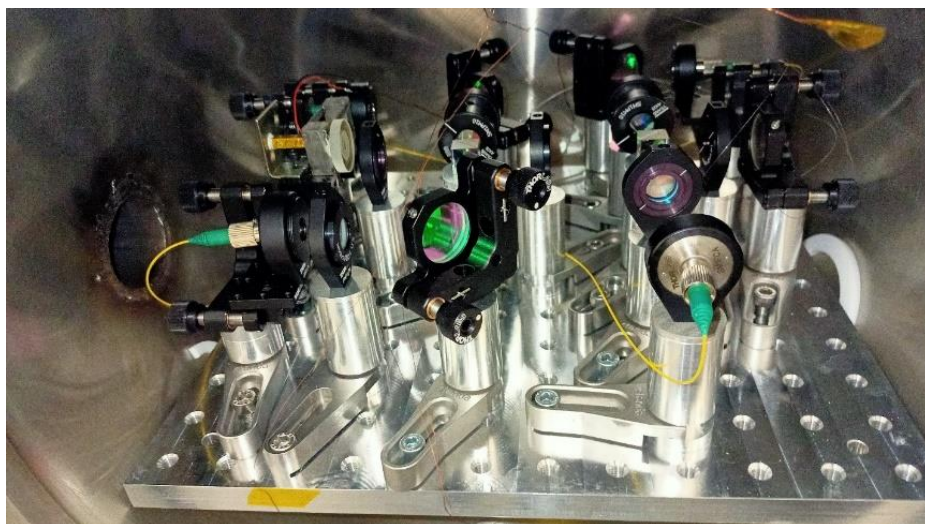
Рис. 41. Лазерная интерферометрическая система в транспондерной схеме внутри вакуумной камеры перед откачкой.
