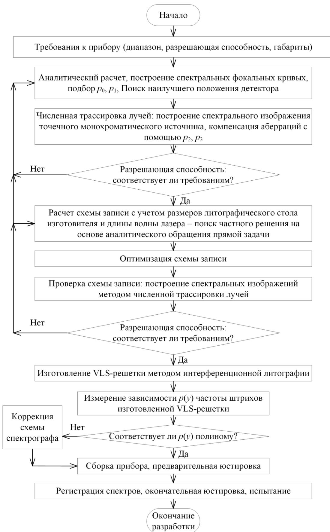
Рис. 27. Блок-схема цикла разработки спектрографов скользящего падения с плоским полем.
