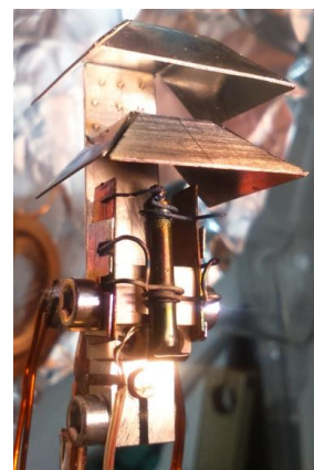
Рис. 14 атомный испаритель на основе трубки из нержавеющей стали
