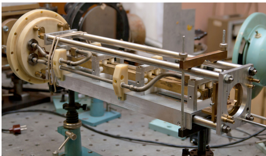
Рис. 2.5. Разрядная камера №2 криогенного щелевого СО лазера с ВЧ возбуждением: внешний вид (а) и вид резонаторного модуля с электродами (б).
