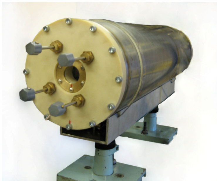
Рис. 2.5. Разрядная камера №2 криогенного щелевого СО лазера с ВЧ возбуждением: внешний вид (а) и вид резонаторного модуля с электродами (б).
