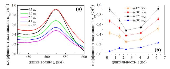
Рис. 4.1. (а) — Спектры экстинкции коллоидных растворов Au HЧ, полученных в деионизированной воде при различных длительностях импульса с основным спектральным пиком, соответствующим локализованному плазмонному резонансу; (b) — изменение коэффициента экстинкции в зависимости от длительности лазерного импульса.
