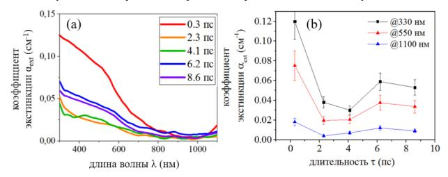
Рис. 4.27. (а) — Спектры коэффициента экстинкции коллоидных растворов НЧ селена, полученных в среде деонизированной воды при  $F_0 \approx 5$  Дж/см²; (b) — изменение коэффициента экстинкции в зависимости от длительности лазерного импульса.
