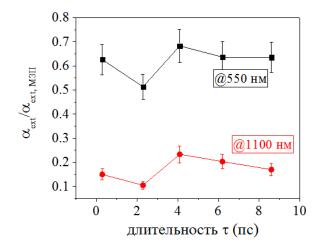
Рис. 4.28. Зависимости коэффициента экстинкции коллоидных растворов НЧ селена в воде, измеренные в различных спектральных точках, нормированные на зависимость в области межзонных переходов.
