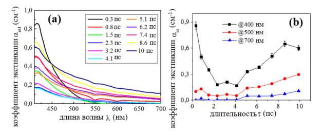
Рис. 4.10. (а) - Спектры экстинкции коллоидных растворов Ag HЧ, полученных в деионизированной воде при различных длительностях импульса с основным спектральным пиком, соответствующим локализованному плазмонному резонансу; (b) — изменение коэффициента экстинкции в зависимости от длительности лазерного импульса.
