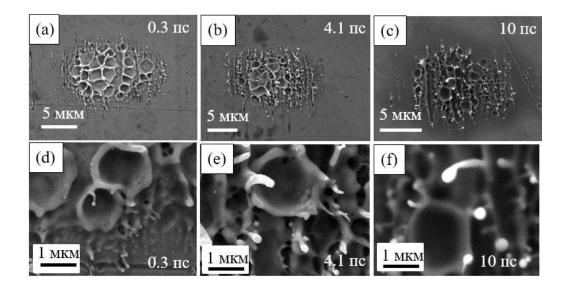
Рис. 3.5. СЭМ изображения одноимпульсных кратеров на поверхности Au в воде при различных значениях длительности импульса (обозначены на изображениях).
