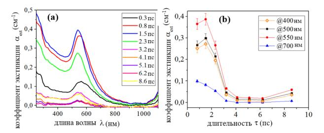
Рис. 4.5. Спектры экстинкции коллоидных растворов Au HЧ, полученных в изопропиловом спирте при различных длительностях импульса с основным спектральным пиком, соответствующим локализованному плазмонному резонансу; (b) — изменение коэффициента экстинкции в зависимости от длительности лазерного импульса.
