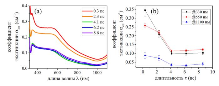
Рис. 4.30. (а) — Спектры коэффициента экстинкции коллоидных растворов Se HЧ, полученных в среде ИП при  $F_0 \approx 5~$  Дж/см $^2$ ; (b) — изменение коэффициента экстинкции в зависимости от длительности лазерного импульса.
