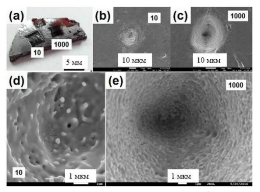
Рис. 5.1. (а) Фотография пластинки селена с областями  $3\times3$  мм², обработанными при различных пиковых плотностях энергии:  $F_0=1$  Дж/см² (слева) и 2 Дж/см² (справа) с экспонированием  $N=2\times10^7$  импульсов (750 импульсов в точку, 33 прохода, заполнение 100 линий/мм) на скорости 3.5 м/с и частотой повторения 2 МГц. СЭМ изображения многоимпульсных (N=10 и  $10^3$ ) одиночных кратеров на поверхности Se при  $F_0=1.35$  Дж/см²: общий (b, c) и увеличенный (d, e) виды.
