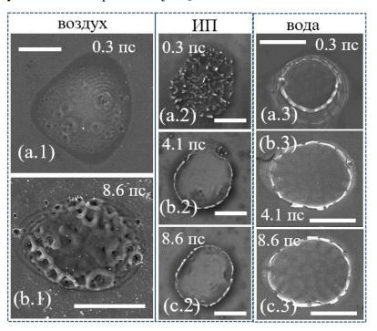
Рис. 3.10. СЭМ изображения одноимпульсных кратеров на поверхности Si в воздухе (а.1, b.1), ИП (а.2, b.2, c.2) и воде (а.3, b.3, c.3) при различных значениях длительности импульса (обозначены на изображениях). Масштабная метка соответствует 10 мкм.
