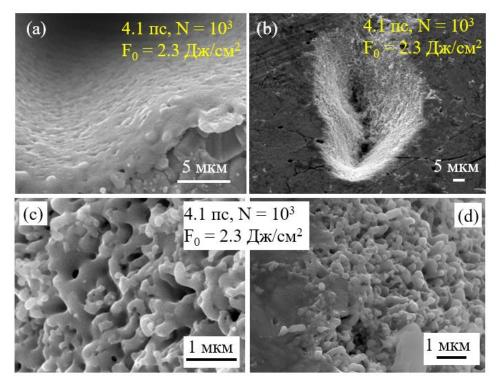
Рис. 3.13. СЭМ изображения микрократеров, полученных на поверхности Se в воздухе (а) и в воде (b - d) при длительности лазерного импульса  $\tau = 4.1$  пс с экспонированием  $N = 10^3$  и поверхностной плотности энергии  $F_0 = 2.3$  Дж/см<sup>2</sup>.
