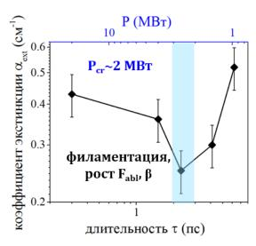
Рис. 4.3. Зависимость коэффициента экстинкции коллоидных растворов НЧ золота в воде в области межзонных переходов (420 нм) в зависимости от длительности импульса и соответствующей пиковой мощности излучения. Синей линией обозначена критическая мощность самофокусировки в деионизированной воде.
