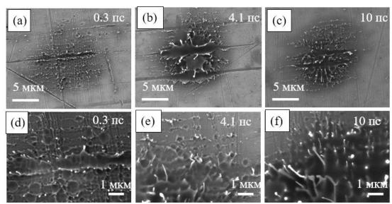
Рис. 3.6. СЭМ изображения одноимпульсных кратеров на поверхности Au в ИП при различных значениях длительности импульса (обозначены в правых верхних углах изображений).
