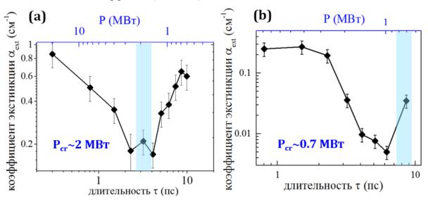
Рис. 4.16. Зависимость коэффициента экстинкции коллоидных растворов НЧ серебра в воде (а) и изопропаноле (b) в области межзонных переходов в зависимости от длительности импульса и соответствующей пиковой мощности излучения. Синей линией обозначена критическая мощность самофокусировки.
