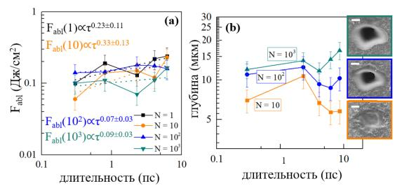
Рис. 3.12. (а) — Вычисленные значения одно- и многоимпульсных порогов абляции в воздухе для различных длительностей импульса; (b) — измеренная глубина многоимпульсных кратеров в зависимости от длительности. Вставки: СЭМ изображения микрократеров, полученных при 0.8 пс с различным лазерным экспонированием ( $N=10,\ 10^2$  и  $10^3$  импульсов в точку, отмечены соответствующими цветами). Масштабная метка соответствует 10 мкм.
