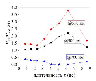
Рис. 4.7. Зависимости коэффициента экстинкции коллоидных растворов НЧ золота в ИП, измеренные в различных спектральных точках, нормированные на зависимость в области межзонных переходов.
