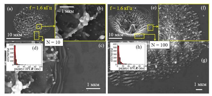
Рис. 3.20. СЭМ изображения многоимпульсных кратеров (N=10 (a - c) и N=100 (e - g)) на поверхности кремния, аблированного в ИП, при различных увеличениях, и соответствующие распределения эжектированных НЧ по размерам (d, h). Частота повторения импульсов f=1.6 кГц, поверхностная плотность лазерной энергии  $F_0 \approx 5$  Дж/см<sup>2</sup>.
