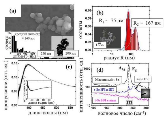
Рис. 5.3. (а) СЭМ изображение наночастиц Se на поверхности кремния. (b) Распределение НЧ селена по размерам, полученное с помощью спектроскопии динамического рассеяния света. Вставка: СЭМ изображение НЧ селена. (c) Спектры пропускания и экстинкции (вставка) гидрозолей НЧ селена, измеренные в диапазоне от УФ до видимого. (d) Спектры комбинационного рассеяния массивного Se (черная кривая) и высушенных коллоидных НЧ, полученных в изопропаноле (синяя кривая) и деионизированной воде (розовая кривая).
