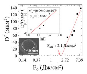
Рис. 2.4. Экспериментальная зависимость  $D^2$ - $F_0$  (черные квадраты) для одноимпульсного воздействия на кремний в воде и ее линейная аппроксимация (красная кривая) с обозначенными параметрами наклона. Стрелкой обозначена пороговая абляционная плотность энергии. Верхняя вставка: график  $D^2$ -LnE. Нижняя вставка: СЭМ изображение микрократера, полученного при одноимпульсном лазерном воздействии в среде изопропанола ( $E \approx 6$  мкДж,  $\tau \approx 0.3$  пс).
