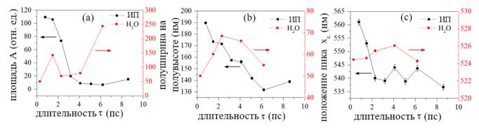
Рис. 4.8. Лоренцева аппроксимация ЛПР-пиков спектров коэффициента экстинкции Аи коллоидных растворов в воде (красные кривые) и в ИП (черные кривые): интегрированная площадь пика A, ширина пика на полувысоте FWHM, положение пика  $x_c$  (ошибки обозначены на графиках, однако не видны на данном масштабе).
