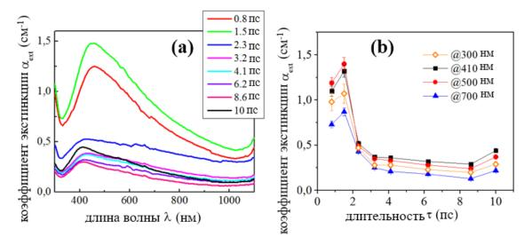
Рис. 4.12. (а) - Спектры экстинкции коллоидных растворов Ag HЧ, полученных в изопропиловом спирте при различных длительностях импульса с основным спектральным пиком, соответствующим локализованному плазмонному резонансу; (b) — изменение коэффициента экстинкции в зависимости от длительности лазерного импульса.
