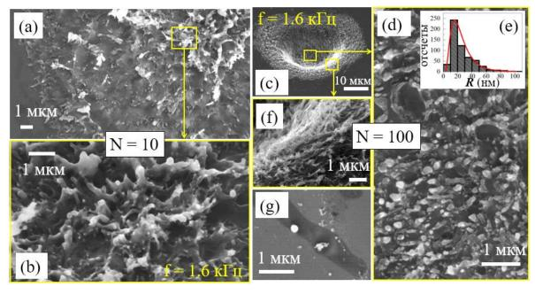
Рис. 3.19. СЭМ изображения многоимпульсных кратеров (N=10 (a - b) и N=100 (c - g)) на поверхности кремния, аблированного в воде, при различных увеличениях. (e) — средний размер поверхностной шероховатости во внутренней части кратера при 100-импульсном экспонировании. Частота повторения импульсов f=1.6 к $\Gamma$ ц, поверхностная плотность лазерной энергии  $F_0\approx 5$  Дж/см<sup>2</sup>.
