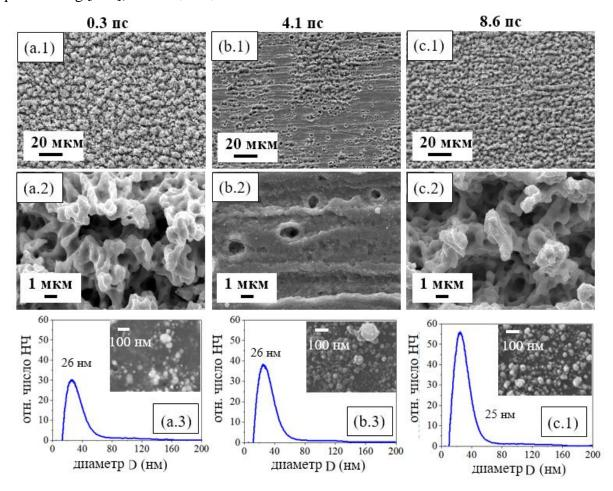
Рис. 4.11. СЭМ изображения поверхности Ag, аблированной под слоем деионизированной воды при длительностях импульса 0.3 пс (a.1, a.2), 4.1 пс (b.1, b.2) и 8.6 пс (c.1, c.2) на различных увеличениях. a.3, b.3, c.3 — соответствующие распределения эжектированных НЧ по размерам, полученные с помощью дисковой центрифуги. Вставки: СЭМ изображения НЧ, высушенных на поверхности кремниевой пластинки.
