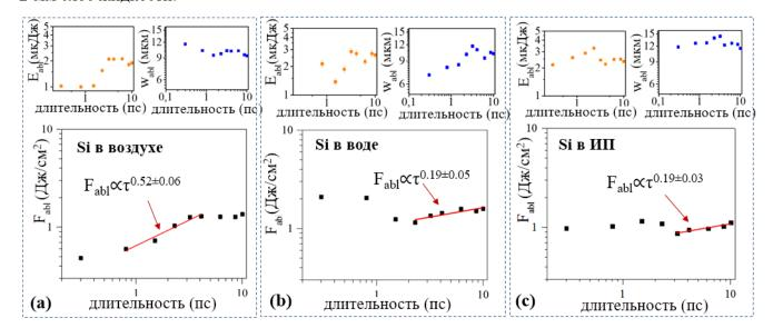
Рис. 3.9. Рассчитанные значения пороговых поверхностных плотностей энергии одноимпульсной абляции, соответствующие пороговые энергии абляции ( $E_{abl}$ , рисунки в левых
