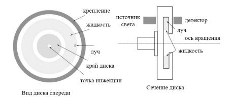
Рис. 2.3. Схематическое изображение аналитической дисковой центрифуги.
