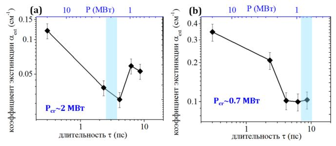
Рис. 4.33. Зависимость коэффициента экстинкции коллоидных растворов НЧ селена в воде (а) и изопропаноле (b) в зависимости от длительности импульса и соответствующей пиковой мощности излучения. Синей линией обозначена критическая мощность самофокусировки.
