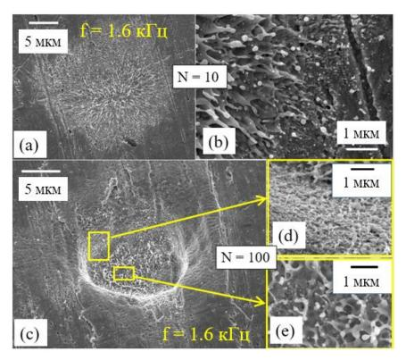
Рис. 3.24. СЭМ изображения многоимпульсных кратеров (N=10 (a, b) и N=100 (c - e)) на поверхности серебра, аблированного в ИП, при различных увеличениях. Частота повторения импульсов f=1.6 к $\Gamma$ ц, поверхностная плотность лазерной энергии  $F_0\approx 5$  Дж/см $^2$ .
