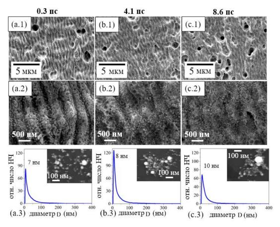
Рис. 4.4. СЭМ изображения поверхности Au, аблированной под слоем деионизированной воды при длительностях импульса 0.3 пс (а.1, а.2), 4.1 пс (b.1, b.2) и 8.6 пс (с.1, с.2) на различных увеличениях. а.3, b.3, с.3 — соответствующие распределения эжектированных НЧ по размерам, полученные с помощью дисковой центрифуги. Вставки: СЭМ изображения НЧ, высушенных на поверхности кремниевой пластинки.
