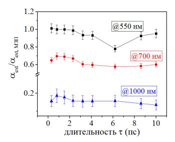
Рис. 4.18. Зависимости коэффициента экстинкции коллоидных растворов НЧ кремния в воде, измеренные в различных спектральных точках, нормированные на зависимость в области межзонных переходов.
