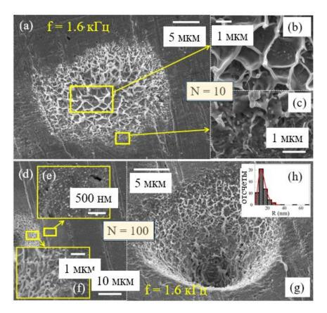
Рис. 3.22. СЭМ изображения многоимпульсных кратеров (N=10 (a - c) и N=100 (d - g)) на поверхности серебра, аблированного в воздухе, при различных увеличениях. (h) — распределение по размерам эжектированных НЧ, расположенных на периферии кратера с N=100. Частота повторения импульсов f=1.6 к $\Gamma$ ц, поверхностная плотность лазерной энергии  $F_0\approx 5$  Дж/см $^2$ .
