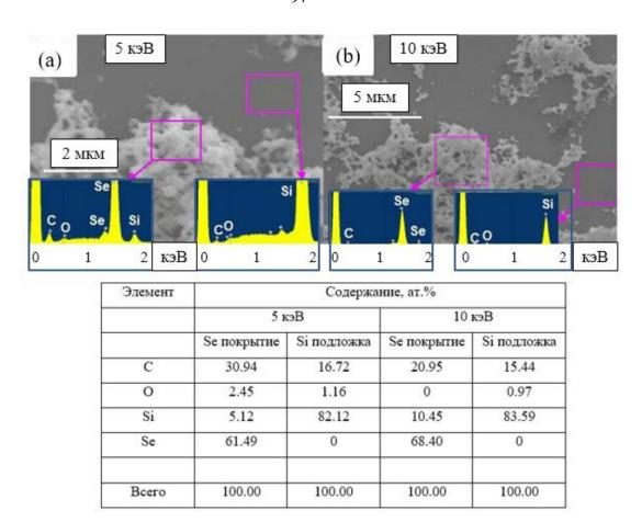
Рис. 5.4. ЭДС анализ НЧ селена на Si подложке со слоем естественного оксида и чистой подложки без НЧ в качестве эталона сравнения при энергиях электронного пучка 5 (а) и 10 кэВ (b). Сверху: СЭМ изображения Se НЧ на Si подложке. Выделенные области обозначают участки, с которых собиралась информация для ЭДС. Снизу: таблица относительного содержания элементов в выделенных областях.
