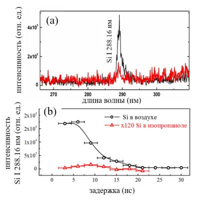
Рис. 3.16. Интенсивность оптической эмиссии спектральной линии Si I 288.16 в абляционных факелах в воздухе (черная кривая) и в ИП (красная кривая); (b) — кинетика оптической эмиссии линии Si I 288.16 для факелов в воздухе и ИП (задержка 3 нс). Поверхностная плотность лазерной энергии  $F_0 \approx 5 \text{ Дж/см}^2$ .
