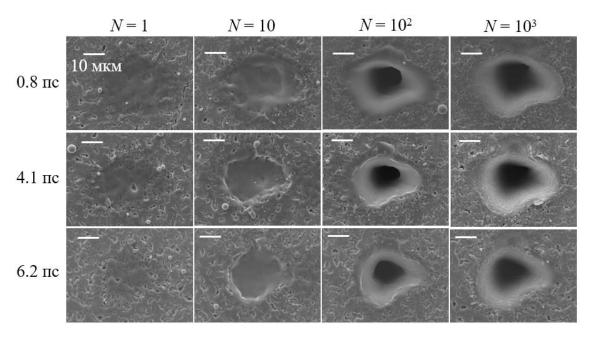
Рис. 3.11. СЭМ изображения микрократеров на поверхности Se в воздухе при различной степени лазерного экспонирования при длительностях импульса 0.8 пс, 4.1 пс и 6.2 пс. Масштабная метка на всех изображениях соответствует 10 мкм.
