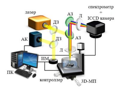
Рис. 3.14. Схема экспериментальной установки для изучения оптической эмиссии абляционных факелов: ДЗ и АЗ — дихроическое и алюминиевое зеркала; ИМ — измеритель мощности; АК — автокоррелятор; Л — линза; 3D-МП — трехкоординатная моторизованная трансляционная платформа с закрепленным на ней образцом; ПК — управляющий компьютер.
