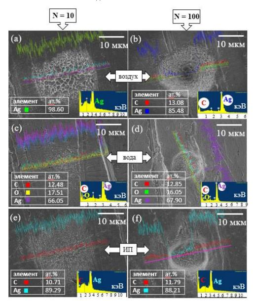
Рис. 3.25. СЭМ изображения многоимпульсных кратеров (N=10 (a) и N=100 (b)) на поверхности серебра в воздухе (a, b), воде (c, d) и ИП (e, f), а также соответствующие таблицы с содержанием элементов. Вставки: энергодисперсионные спектры (по ординате — количество
