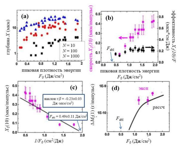
Рис. 5.2. (а) Зависимости глубины кратеров X от  $F_0$  для различного количества импульсов  $N=10,\,10^2$  и  $10^3$ . (b) Зависимость  $X_1(10)$  от  $F_0$ .  $F_{abl}$  – порог абляции. (c) Зависимость  $X_1(10)$  от  $1/F_0$
