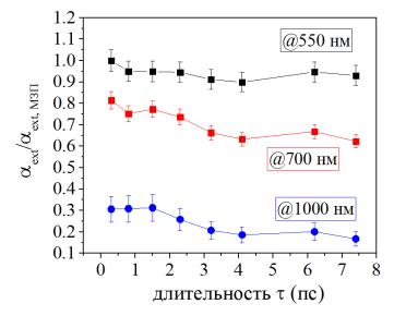
Рис. 4.21. Зависимости коэффициента экстинкции коллоидных растворов НЧ кремния в ИП, измеренные в различных спектральных точках, нормированные на зависимость в области межзонных переходов.
