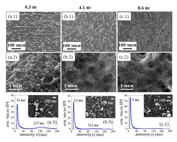
Рис. 4.15. СЭМ изображения поверхности Ag, аблированной под слоем изопропилового спирта при длительностях импульса 0.3 пс (a.1, a.2), 4.1 пс (b.1, b.2) и 8.6 пс (c.1, c.2) на различных увеличениях. a.3, b.3, c.3 — соответствующие распределения эжектированных НЧ по размерам, полученные с помощью дисковой центрифуги. Вставки: СЭМ изображения НЧ, высушенных на поверхности кремниевой пластинки.
