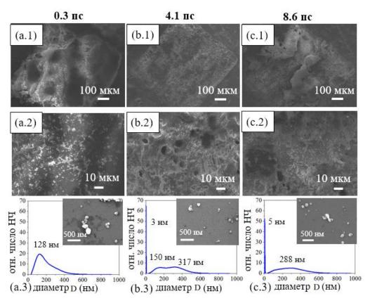
Рис. 4.29. СЭМ изображения поверхности Se, аблированной под слоем воды при длительностях импульса 0.3 пс (a.1, a.2), 4.1 пс (b.1, b.2) и 8.6 пс (c.1, c.2) при  $F_0 \approx 5$  Дж/см<sup>2</sup> на различных увеличениях. (a.3, b.3, c.3) — соответствующие распределения вынесенных НЧ по размерам, полученные с помощью дисковой центрифуги. Вставки: СЭМ изображения НЧ, высушенных на пластинках кремния.
