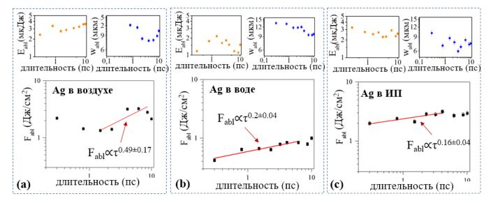
Рис. 3.7. Рассчитанные значения пороговых поверхностных плотностей энергии одноимпульсной абляции, соответствующие пороговые энергии абляции ( $E_{abl}$ , рисунки в левых верхних углах) и  $1/e^2$  радиусы гауссова пучка ( $w_{abl}$ , рисунки в правых верхних углах) для Ag мишени, аблированной в воздухе (a), воде (b) и ИП (c).
