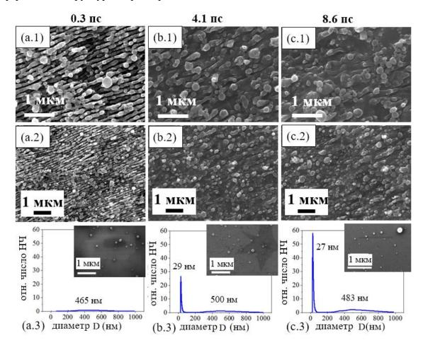
Рис. 4.22. СЭМ изображения поверхности Si, аблированной под слоем изопропилового спирта при длительностях импульса 0.3 пс (а.1, а.2), 4.1 пс (b.1, b.2) и 8.6 пс (с.1, с.2) на различных увеличениях. а.3, b.3, с.3 — соответствующие распределения эжектированных НЧ по размерам, полученные с помощью дисковой центрифуги. Вставки: СЭМ изображения НЧ, высушенных на поверхности кремниевой пластинки.
