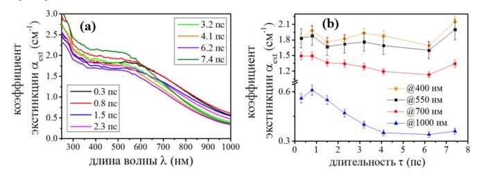
Рис. 4.20. (а) - Спектры экстинкции коллоидных растворов Si HЧ, полученных в изопропиловом спирте при различных длительностях импульса; (b) — изменение коэффициента экстинкции в зависимости от длительности лазерного импульса.
