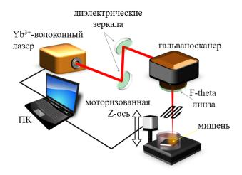
Рис. 2.1. Экспериментальная схема установки для генерации коллодных растворов НЧ.
