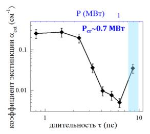
Рис. 4.6. Зависимость коэффициента экстинкции коллоидных растворов НЧ золота в изопропаноле в области межзонных переходов в зависимости от длительности импульса и соответствующей пиковой мощности излучения. Синей линией обозначена критическая мощность самофокусировки в ИП.
