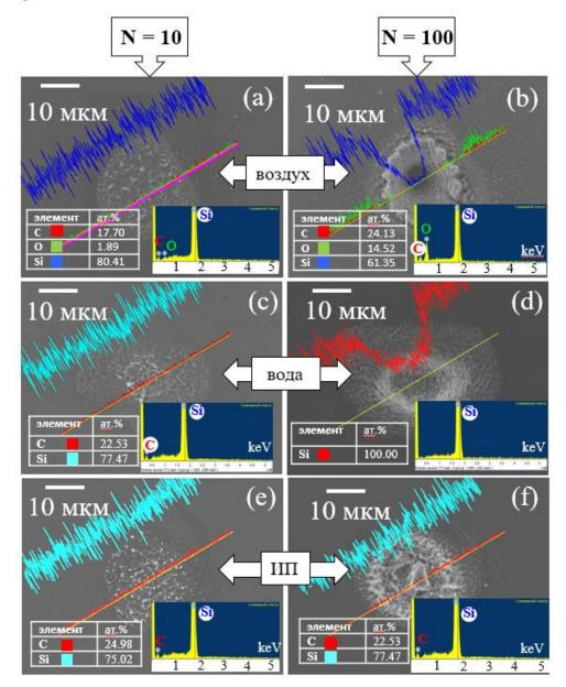
Рис. 3.21. СЭМ изображения многоимпульсных кратеров (N=10 (левая колонка) и N=100 (правая колонка)) на поверхности кремния в воздухе (a, b), воде (c, d) и ИП (e, f), а также соответствующие таблицы с содержанием элементов. Вставки: энергодисперсионные спектры (по ординате — количество зарегистрированных отсчетов). Частота повторения импульсов f=1.6 кГц, поверхностная плотность лазерной энергии  $F_0 \approx 5$  Дж/см<sup>2</sup>.
