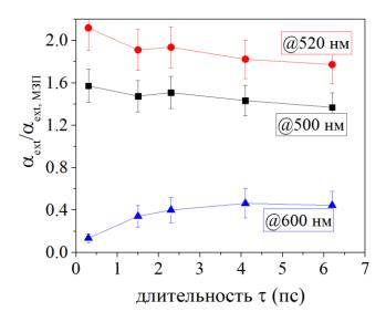
Рис. 4.2. Зависимости коэффициента экстинкции коллоидных растворов НЧ золота в воде, измеренные в различных спектральных точках, нормированные на зависимость в области межзонных переходов.
