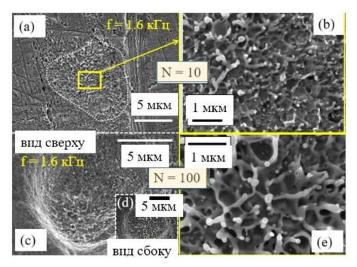
Рис. 3.23. СЭМ изображения многоимпульсных кратеров (N=10 (a, b) и N=100 (c-e)) на поверхности серебра, аблированного в деионизированной воде, при различных увеличениях. Кратер на (а) выделен пунктирной линией для лучшего восприятия. Частота повторения импульсов f=1.6 к $\Gamma$ ц, поверхностная плотность лазерной энергии  $F_0\approx 5$  Дж/см $^2$ .
