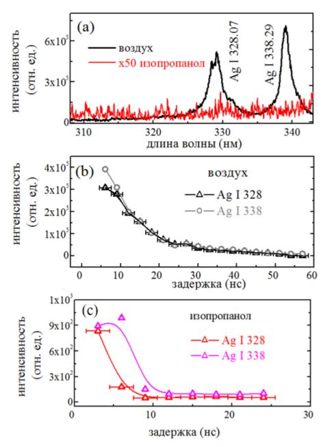
Рис. 3.17. (а) — Спектры оптической эмиссии абляционных факелов Ag в воздухе (черная кривая) и изопропаноле (красная кривая), полученные с задержкой 3 нс. Кинетика эмиссии Ag I 328 и Ag I 338 линий в воздухе (b) и ИП (c). Поверхностная плотность лазерной энергии  $F_0 \approx 5$  Дж/см<sup>2</sup>.
