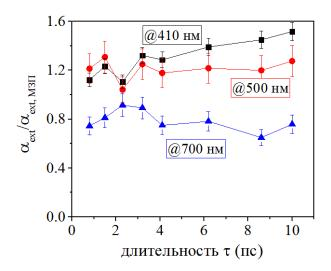
Рис. 4.13. Зависимости коэффициента экстинкции коллоидных растворов НЧ серебра в ИП, измеренные в различных спектральных точках, нормированные на зависимость в области межзонных переходов.
