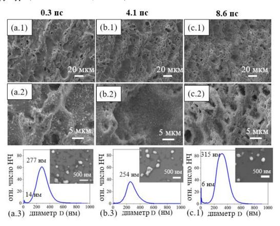
Рис. 4.32. СЭМ изображения поверхности Se, аблированной под слоем ИП при различных значениях длительности лазерного импульса: 0.3 пс (a.1, a.2), 4.1 пс (b.1, b.2) и 8.6 пс (c.1, c.2) при  $F_0 \approx 5$  Дж/см<sup>2</sup> с различным увеличением. (a.3, b.3, c.3) — соответствующие распределения НЧ по
