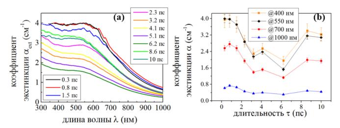
Рис. 4.17. (а) - Спектры коэффициента экстинкции коллоидных растворов Si HЧ, полученных в деионизированной воде при различных длительностях импульса; (b) – изменение коэффициента экстинкции в зависимости от длительности лазерного импульса.
