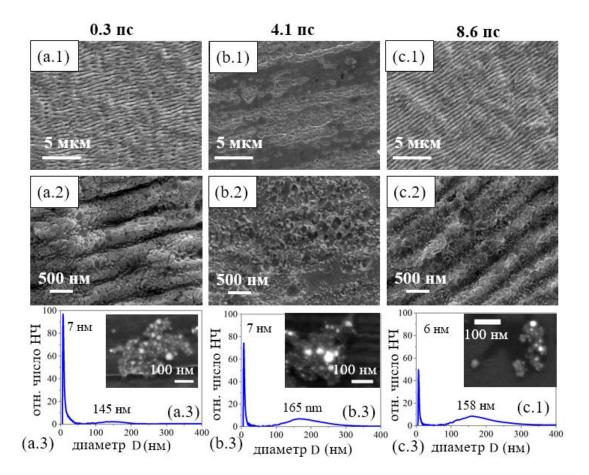
Рис. 4.9. СЭМ изображения поверхности Au, аблированной под слоем изопропилового спирта при длительностях импульса 0.3 пс (а.1, а.2), 4.1 пс (b.1, b.2) и 8.6 пс (с.1, с.2) на различных увеличениях. а.3, b.3, с.3 — соответствующие распределения эжектированных НЧ по размерам, полученные с помощью дисковой центрифуги. Вставки: СЭМ изображения НЧ, высушенных на поверхности кремниевой пластинки.
