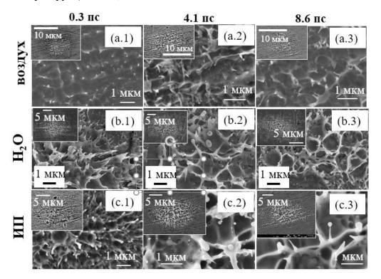
Рис. 3.8. СЭМ изображения одноимпульсных кратеров на поверхности Ag в воздухе (а.1, а.2, а.3), воде (b.1, b.2, b.3) и ИП (с.1, с.2, с.3) при различных значениях длительности импульса. Вставки: СЭМ изображения кратеров при меньшем увеличении.
