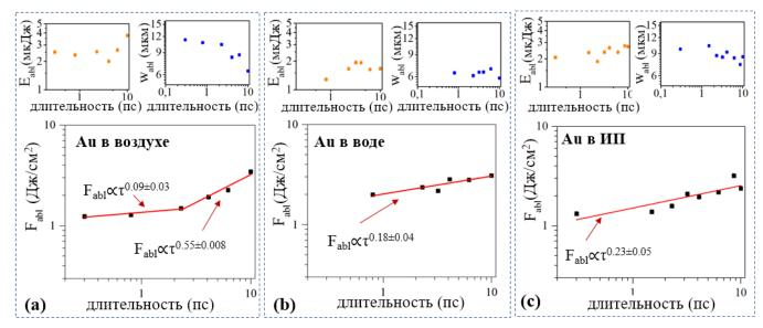
Рис. 3.1. Рассчитанные значения пороговых поверхностных плотностей энергии одноимпульсной абляции, соответствующие пороговые энергии абляции ( $E_{abl}$ , рисунки в левых верхних углах) и  $1/e^2$  радиусы гауссова пучка ( $w_{abl}$ , рисунки в правых верхних углах) для Au мишени, аблированной в воздухе (a), воде (b) и ИП (c).
