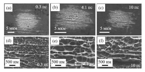
Рис. 3.2. СЭМ изображения одноимпульсных кратеров на поверхности Au в воздухе при различных значениях длительности импульса (обозначены в правых верхних углах изображений).
