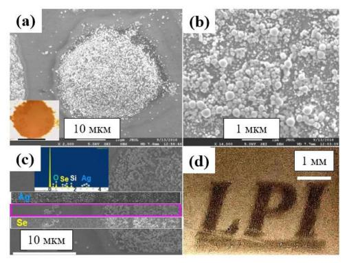
Рис. 5.6. СЭМ изображения отдельных высушенных капель Se наночернил на 50-нм серебряной пленке, нанесенной на силикатное стекло: общий вид (а) и увеличенное изображение (b и c) с ЭДС-вставками, иллюстрирующими содержание Se и Ag в выделенной области (фиолетовый прямоугольник) (c). Изображение тестовой напечатанной надписи, полученное с помощью оптического микроскопа.
