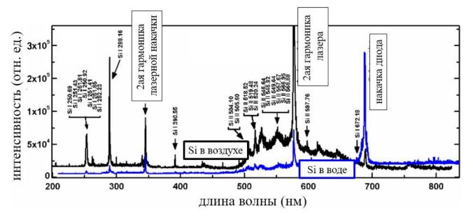
Рис. 3.15. Спектры оптической эмиссии Si факелов в воздухе (верхняя черная кривая) и в воде (нижняя синяя кривая), полученные с задержкой 10 нс. Поверхностная плотность лазерной энергии  $F_0 \approx 5 \text{ Дж/см}^2$ .
