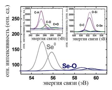
Рис. 5.5. РФС спектры связанных энергий Se HЧ на Si подложке с естественным слоем оксида. Вставки: спектры углерода (С, слева) и кислорода (О, справа) для Se HЧ (жирные кривые) и чистой кремниевой пластины (тонкие кривые). Расшифровка спектральных линий осуществлялась согласно базе данных Национального института стандартов и технологий для РФС-анализа [163].
