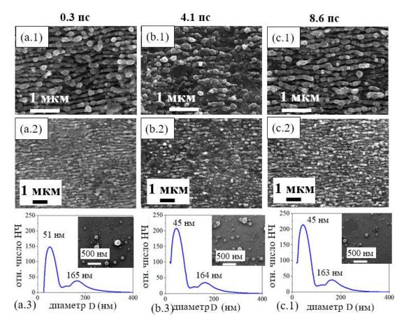
Рис. 4.19. СЭМ изображения поверхности Si, аблированной под слоем деионизированной воды при длительностях импульса 0.3 пс (а.1, а.2), 4.1 пс (b.1, b.2) и 8.6 пс (с.1, с.2) на различных увеличениях. а.3, b.3, с.3 — соответствующие распределения эжектированных НЧ по размерам, полученные с помощью дисковой центрифуги. Вставки: СЭМ изображения НЧ, высушенных на поверхности кремниевой пластинки.
