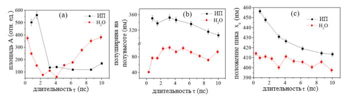
Рис. 4.14. Лоренцева аппроксимация ЛПР-пиков спектров коэффициента экстинкции Ag коллоидных растворов в воде (красные кривые) и в ИП (черные кривые): интегрированная площадь пика A, ширина пика на полувысоте FWHM, положение пика  $x_c$  (ошибки обозначены на графиках, однако не видны на данном масштабе).
