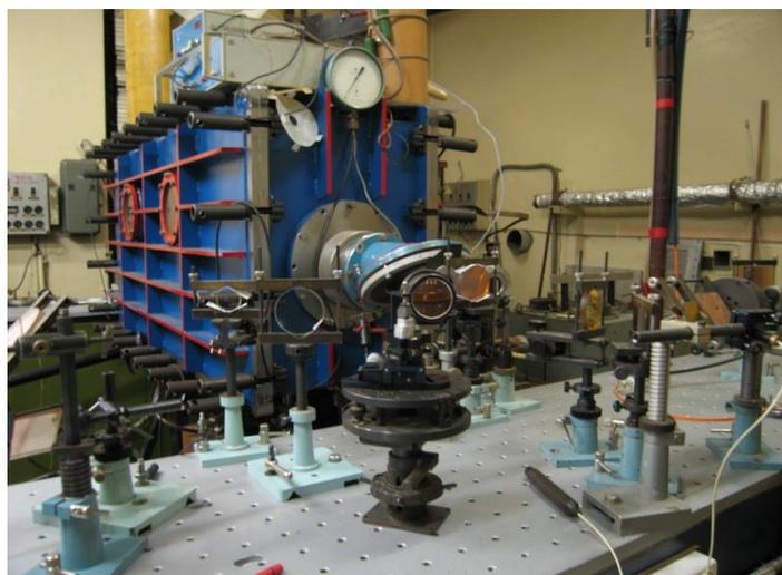
Рис.4.1 Внешний вид импульсного криогенного электроионизационного СО лазера.
