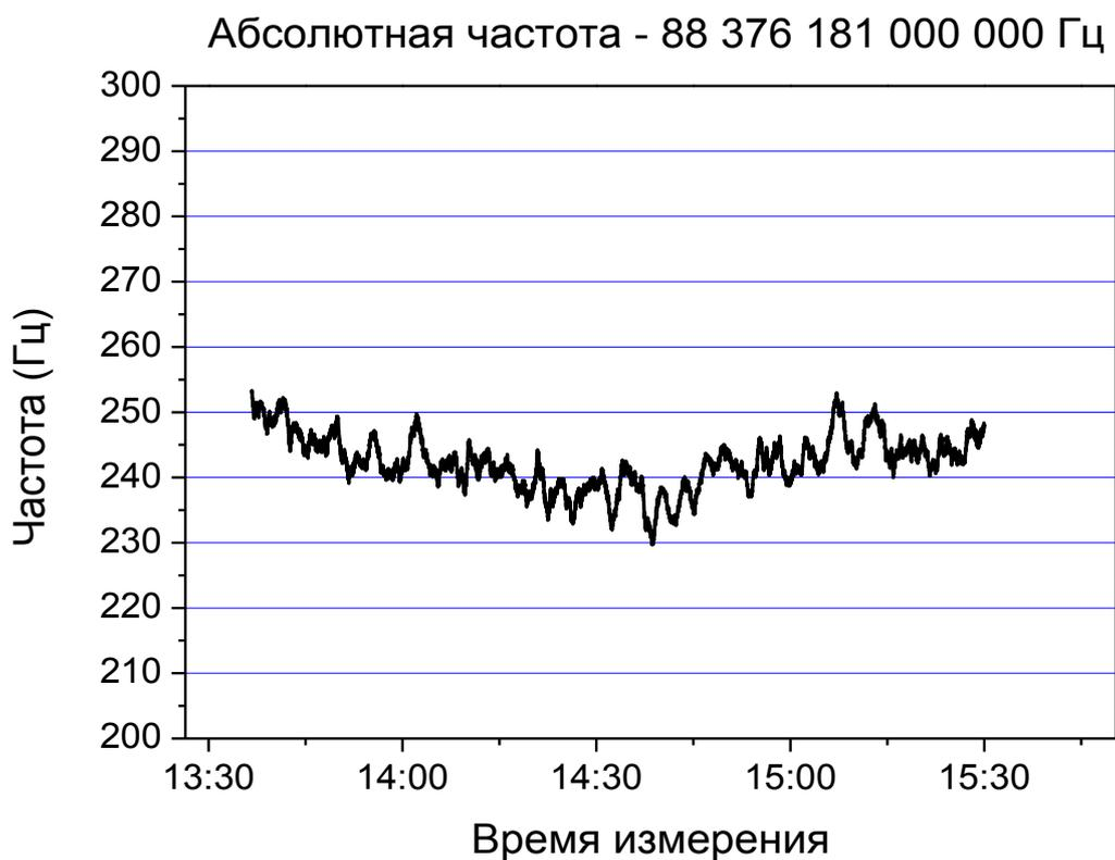
Рис. 3.1. Типичная запись абсолютных частотных измерений ТОСЧ-60 на радиооптическом мосту РТВ (Германия) относительно цезиевого репера, проводившихся в декабре 2000 г. (время усреднения 100 с).
