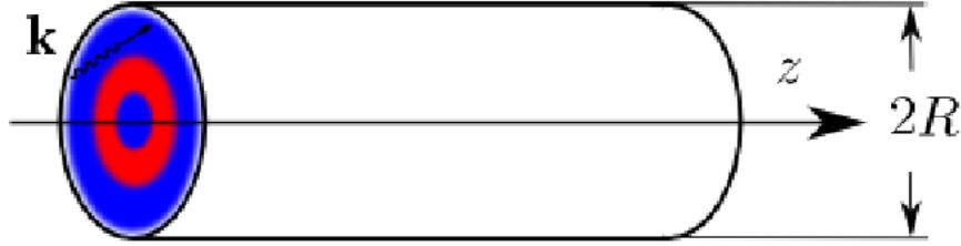
Рис. 3.11. Схематическое изображение цилиндрического волновода и распространяющейся в нем электромагнитной волны. Красным цветом показаны максимумы амплитуды волны, а синим - минимумы.
