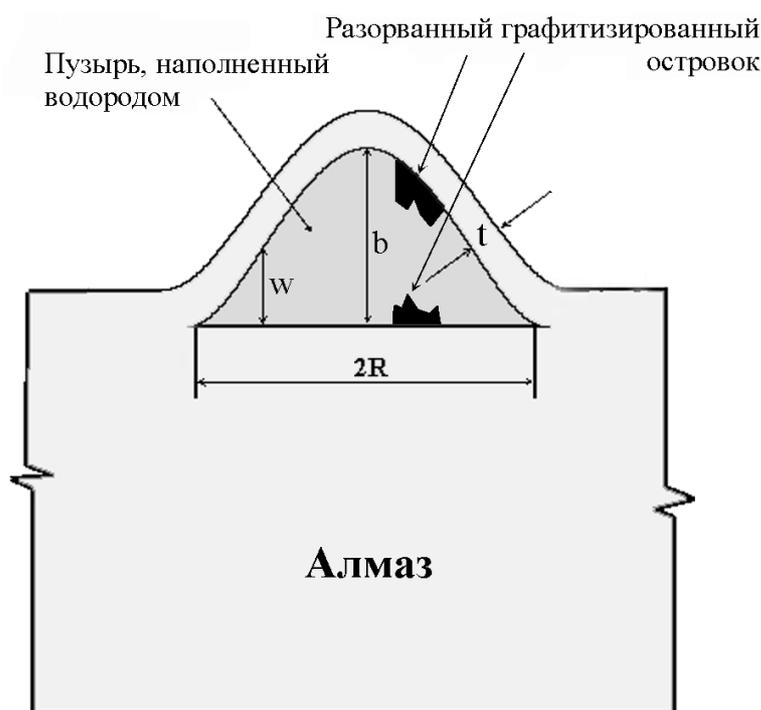
Рис. 6. Модель пузыря в плоскости оси симметрии
