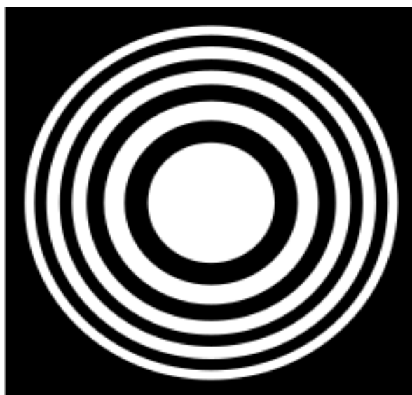
Рисунок 19. Схематическое изображение зонной пластинки.
