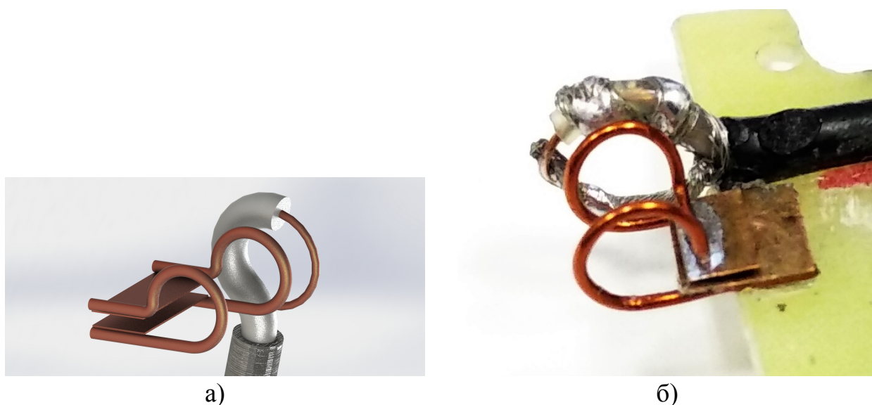
Рисунок 1.12 — Квазигельмгольцевский резонатор. (а) Компьютерная модель. (б) изготовленный резонатор.
