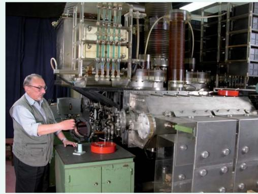
Импульсный лазер на атомарных переходах благородных газов. Оптическую схему юстирует д.ф.-м.н. И.В. Холин
