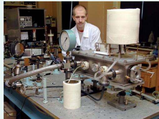
А. Козлов за юстировкой криогенного СО лазера с накачкой высокочастотным емкостным разрядом
