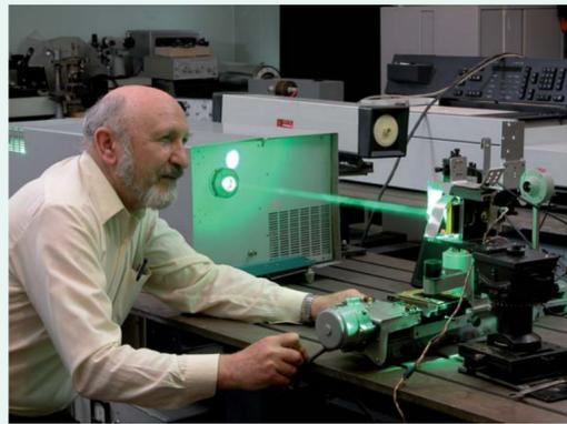
Установка для лазерной печати, созданная в лаборатории полупроводниковых лазеров с электронной накачкой
