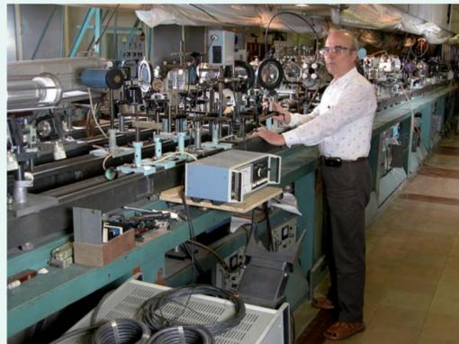
МКГ-2 Мощный квантовый генератор с максимальной световой энергией накачки до 2 МДж. Ефимков В.Ф.
